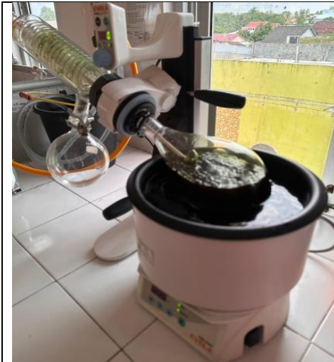
Proses pemisahan pelarut dengan larutan menggunakan alat rotary evaporator
