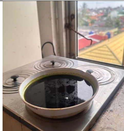
Proses pengentalan ekstrak dengan alat waterbath
