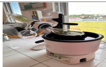
Proses pemisahan ekstrak daun pegagan dengan pelarut etanol menggunakan alat rotary evaporator
