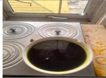
Proses pengentalan ekstrak daun sirih hijau menggunakan waterbath
