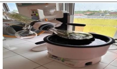
Proses pemisahan ekstrak daun sirih hijau dengan pelarut etanol menggunakan alat rotary evaporator
