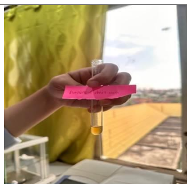
Uji flavonoid daun sirih hijau
