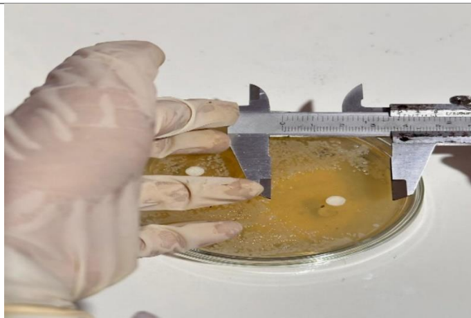
Pengukuran zona bening menggunakan jangka sorong
