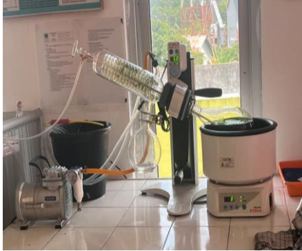
Rotary Evaporator (Proses pemisahan antara ekstrak daun pegagan dan ekstrak daun sirih hijau dengan pelarut etanol)
